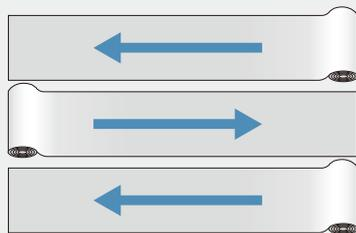
※アルトロセーフティフロア、アルトロアクエアスを施工の際、骨材密度に差がある場合は隣合わせのシートの骨材密度をできるだけ合わせてください。
