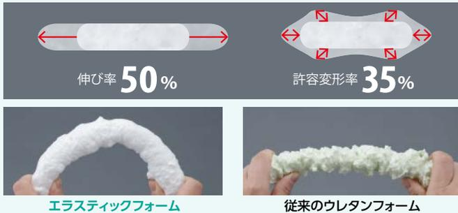
従来の1液タイプのウレタンフォームに比べ驚異的な柔軟性を実現しました。そのため、硬化後も金属や木材などの建築素材の収縮に追従し、断熱・気密性能を長期間保持します。左記の写真はその柔軟性を示すものです。
