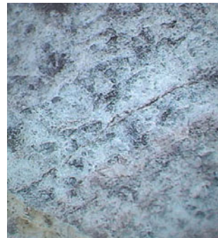
微細な連続空隙(クラック)の拡大写真 (1,000倍)
