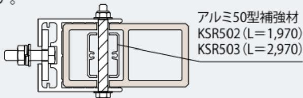
※カオスブレード材とアルミ50型補強材に穴あけ加工をして出荷することも可能です。
