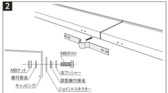
2 専用ボルトセットでジョイントコネクタを取り付け。(皿型歯付座金が平らにつぶれるまでボルトをしめてください。)
