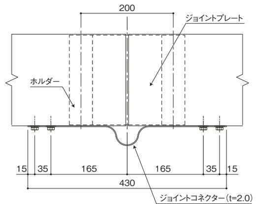
新JIS(JIS A 4201(2003))により本受雷部システムをご採用いただく場合は、笠木の下部に着火する可燃物がない事が条件となります。
