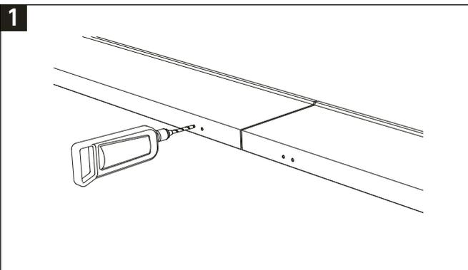
1 キャッピング取り付け後、キャッピング所定位置にジョイントコネクタ取付穴をあけます。(Φ8.3mm)
