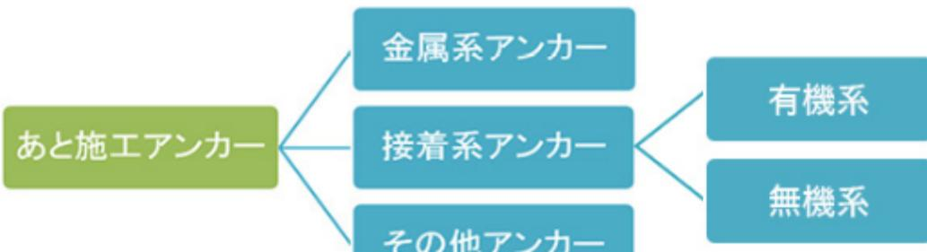
この度発売した「ABC無機アンカー」は接着系アンカーでありながら、エポキシ樹脂等の有機系材料による接着ではなく、セメントを主材とする無機系材料なのでコンクリートと一体化するなどの様々な利点を生み出します。
