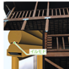
ログハウス ログハウスのログ間やノッチ部分の断熱充填材として。
