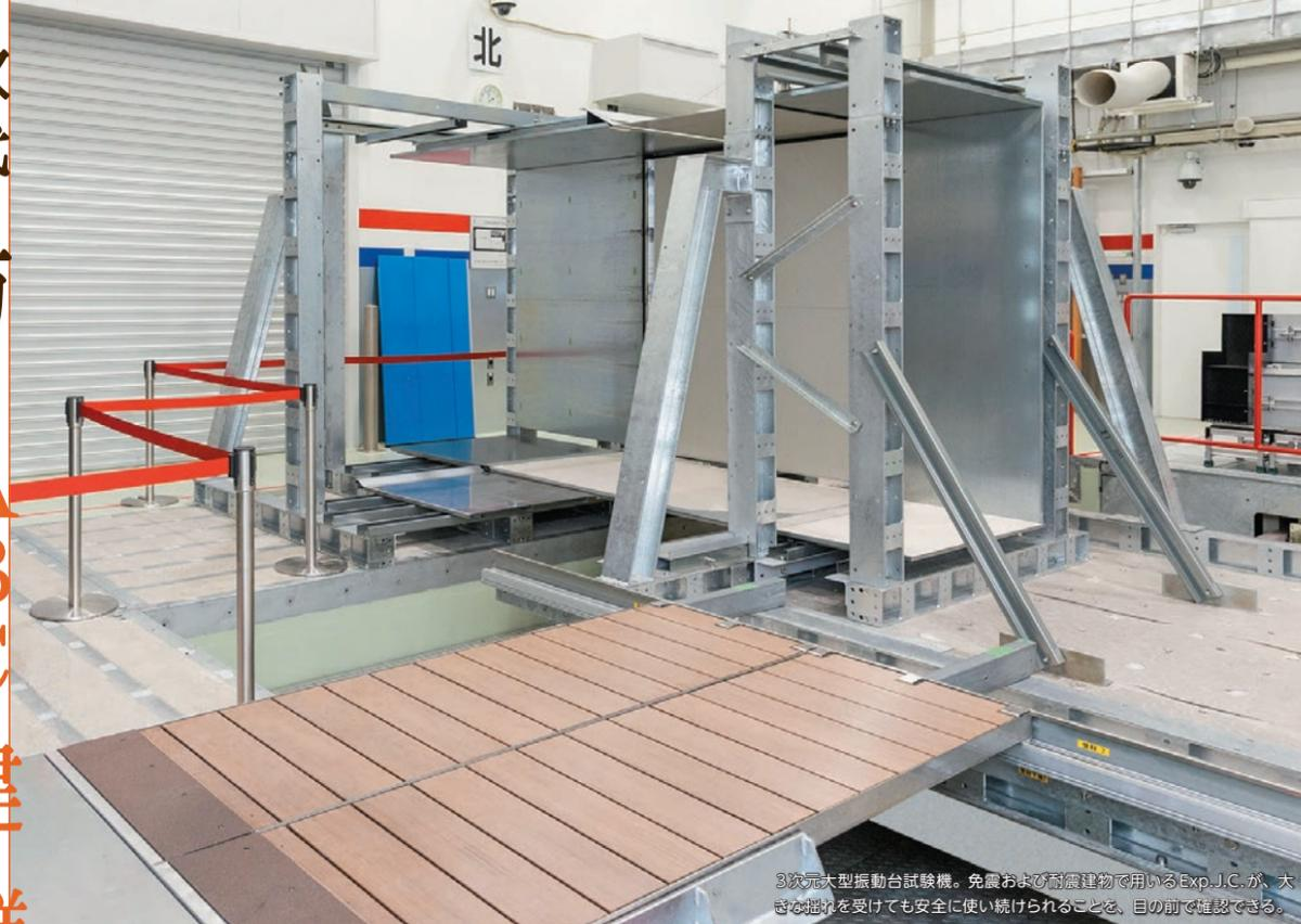
3次元大型振動台試験機。免震および耐震建物で用いるExp.J.C.が、大きな揺れを受けても安全に使い続けられることを、目の前で確認できる。
