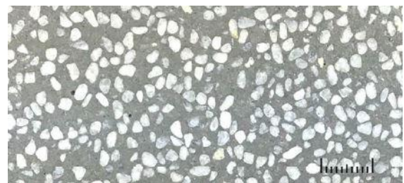
骨材粒径は 2~4mm を使用していますが、天然骨材のためバラつきが生じることがあります。
